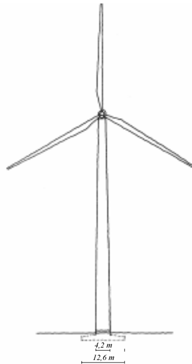
Principskitse af en 2MW mølle med fundament
