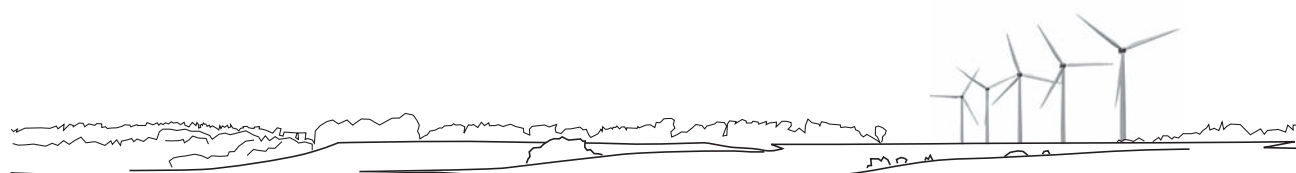
Mølleopstilling i område med store terrænspring, hvor tårnhøjden er korrigeret for højdeudligning
