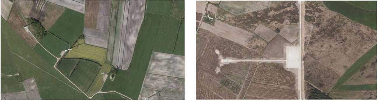
Figur 2.3.1. Vindmøller på a) dyrkede marker ved Drøstrup og b) Testcenteret i Østerild, i Jammerbugt og Thisted Kommune (målestoksforholdet er ens på de to figurer). Møllerne i Drøstrup er opført i 2011 og har en højde på 80-90 meter (2,3 MW). Standpladsen i Østerild er anlagt med henblik på opsætning af møller op til 150 meter. Vindmøller på land opføres i dag typisk med totalhøjder på 125-165 meter. Behovet for arealinddragelse til fundament, arbejds- og vendepladser og adgangsveje vil være større end anlægget i Drøstrup og mindre end Testcentret i Østerild.
